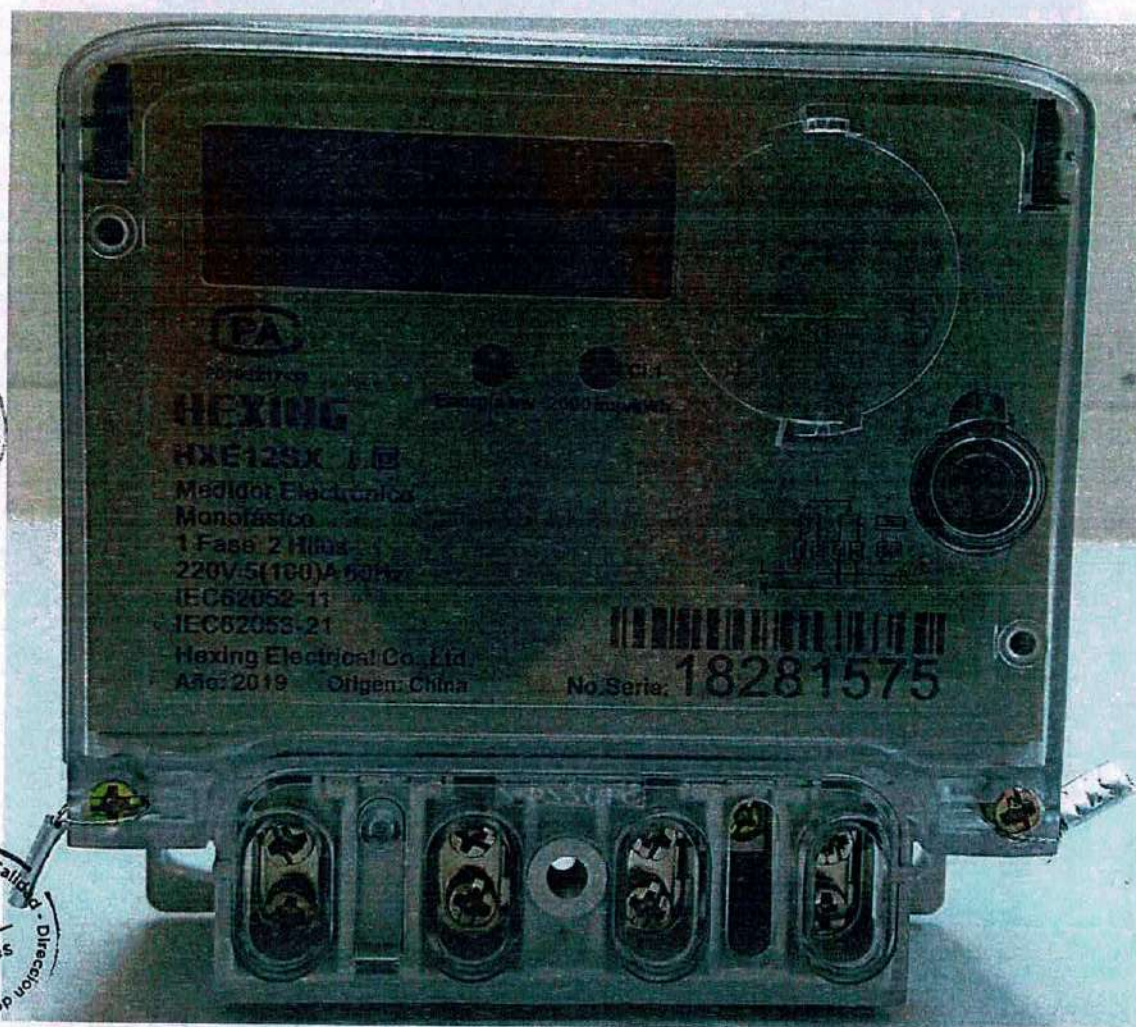
Fotografía 3. Vista frontal del medidor evaluado sin tapa de bornes
