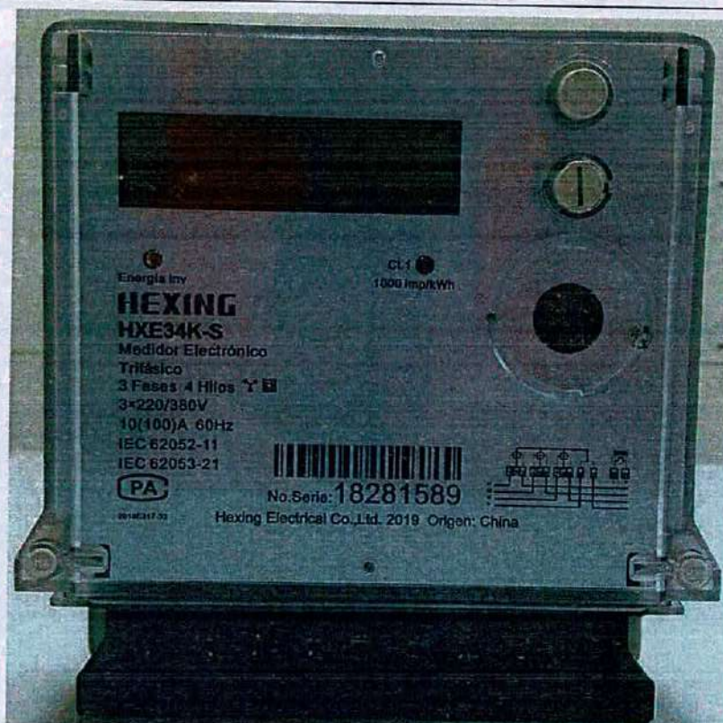
Fotografía 3. Vista frontal del medidor evaluado sin tapa de bornes
